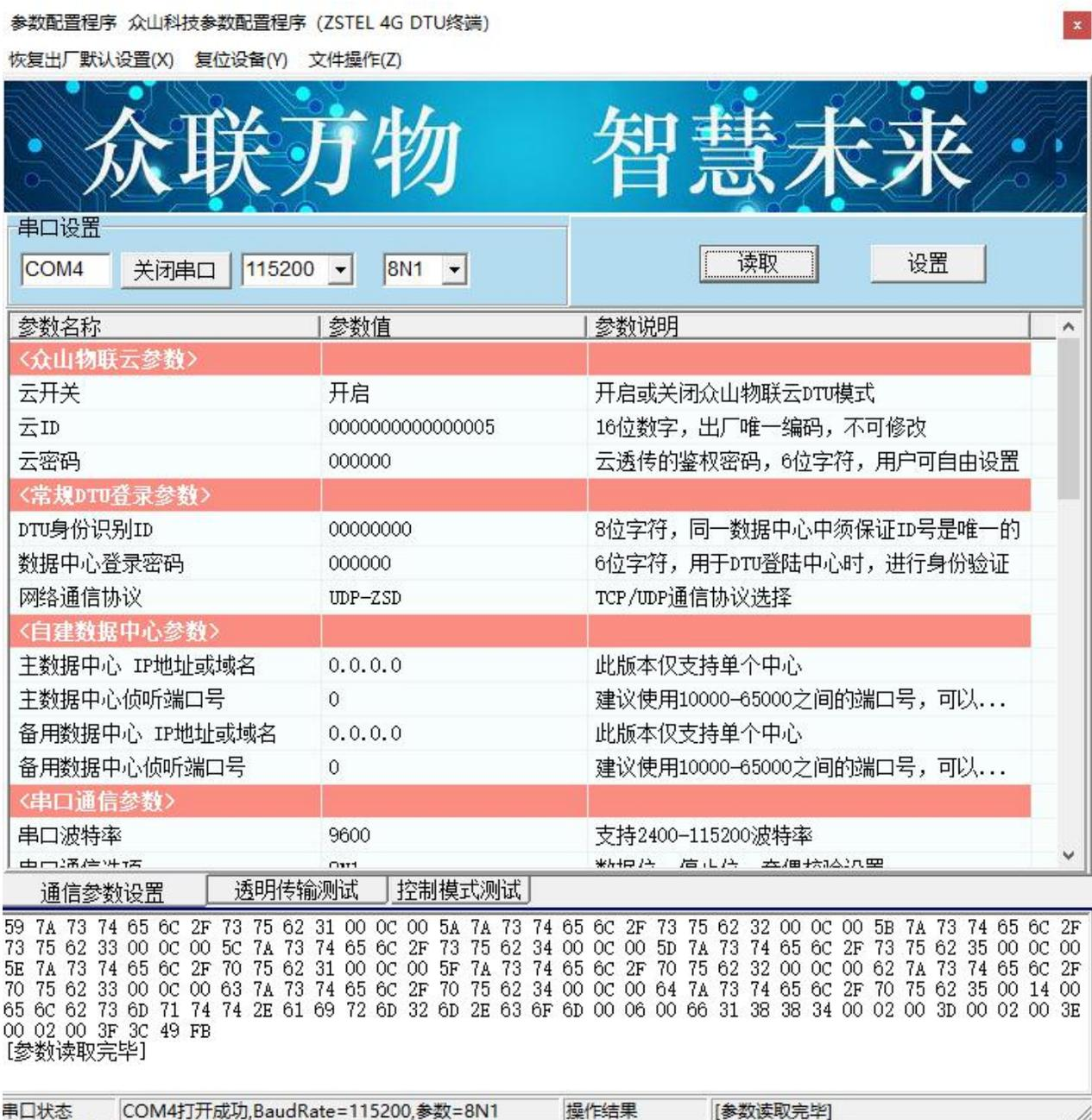
\*运行DTUCFG.exe前一定要按照“配置软件使用说明”的步骤操作 \*如果出现不能读取出现设备参数的情况，注意
